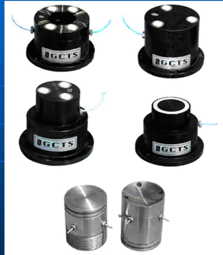
Si eccita il sensore sorgente tramite un segnale elettrico (onda sinusoidale) in modo che deformandosi emetta onde di taglio di ampiezza costante all'interno del provino.
